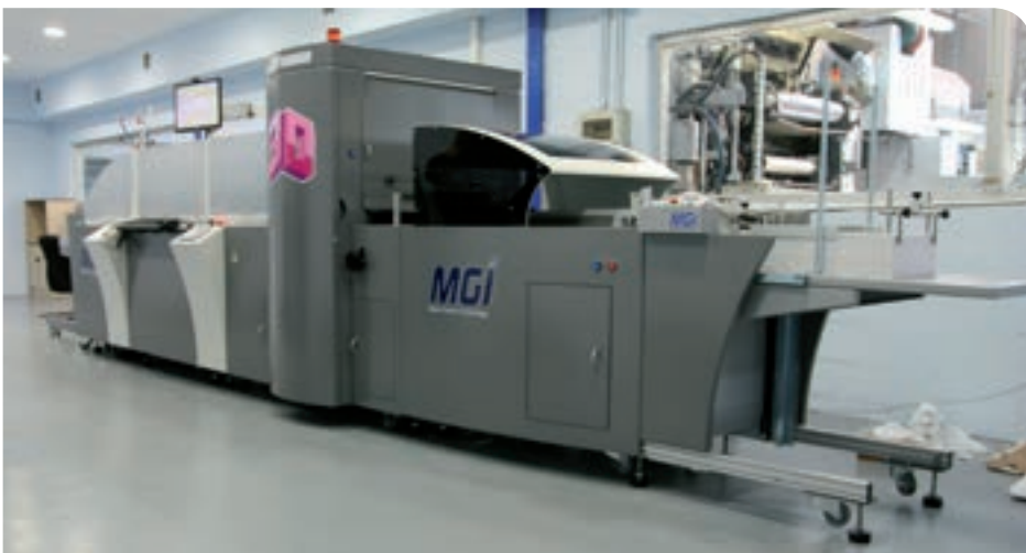
La MGI JETvarnish 3D instalada y operativa en una sala con entorno controlado.
