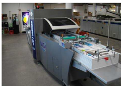
flyeralarm hat als erste Druckerei in Deutschland eine MGI Jet Varnish in Betrieb genommen.
