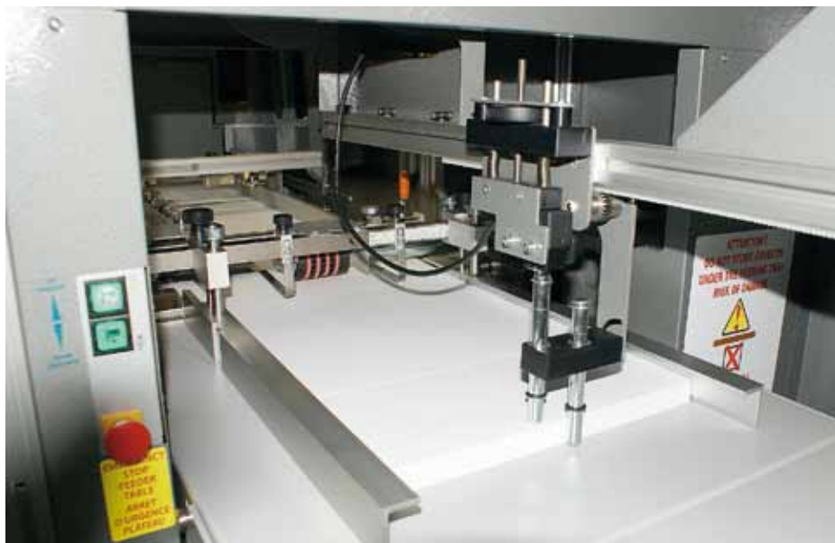
Le margueur haute précision dispose d'un système de détection à ultrason de doubles feuilles.
