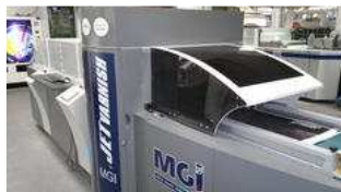
Die MGI Jet Varnish arbeitet mit dem Inkjetverfahren und soll so Veredelungen bereits ab Auflage eins wirtschaftlich machen.
