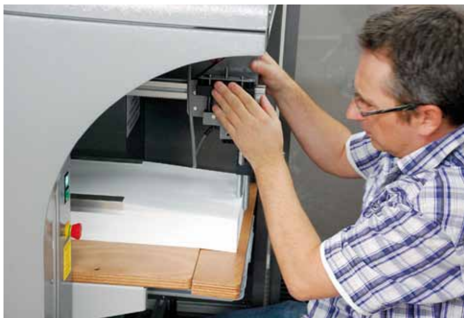
Die Meteor DP 60 ist bei der Bogenzuführung wie eine Offsetmaschine konstruiert.
