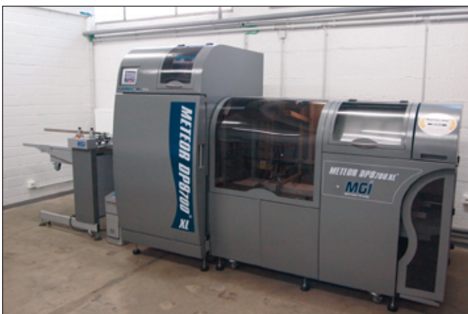
Die MGI DP-8700 XL bei farbo prepress ist mit einem Offset-Anleger bestückt, wodurch eine Passergenauigkeit von bis zu 0,2 mm pro A4-Seite erreicht wird.
